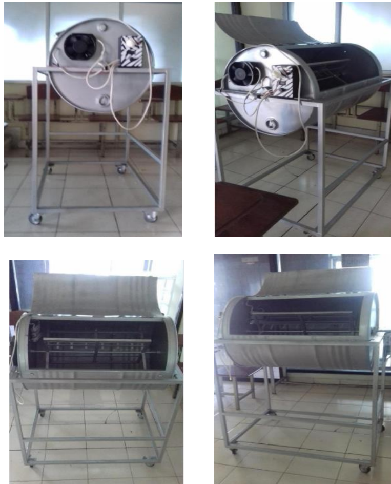
Gambar 3.3. Hasil Desain Mesin Pengering Sepatu
