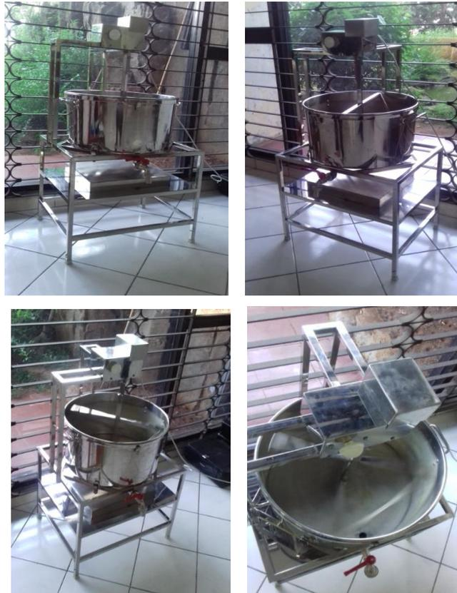
Gambar 3.6. Hasil Desain Mesin Pemasak Sirup Parijoto
