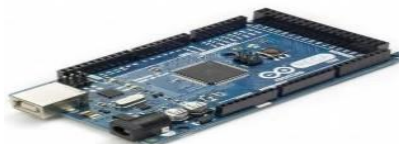
Gambar 1. Arduino Mega 2560 (Arifin, J., Zulita, L. N., & Hermawansyah, 2016).
