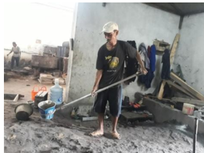
Gambar 4. Proses Penuangan Cairan Logam Setelah Perbaikan
