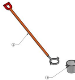
Gambar 3. 3D View Desain Alat Penuang Cairan Logam
