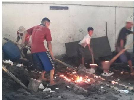
Gambar 2. Proses Penuangan Cairan Logam Sebelum Perbaikan
