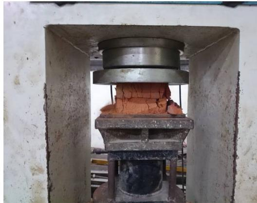
Gambar 6 Setelah pengujian kuat tekan
