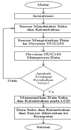
Gambar 5. Diagram alir program mikropengendali
