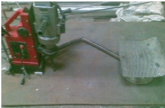
Gambar 5. Mesin Bor Desain Baru
