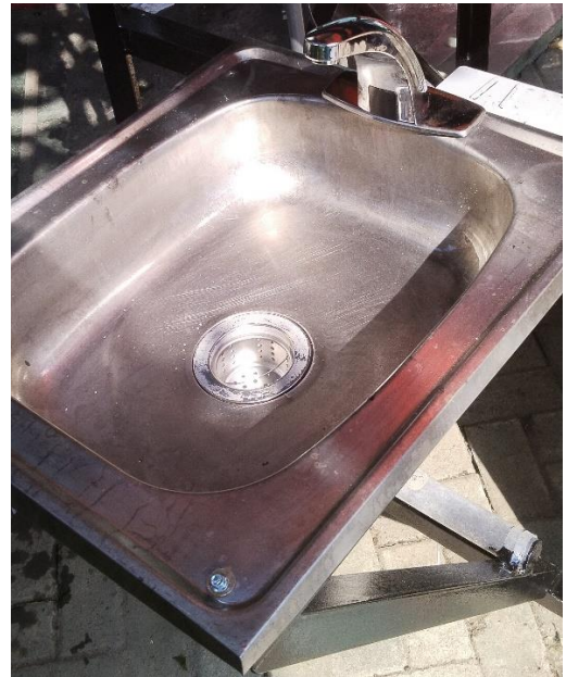
Gambar 6. Wastafel yang telah di modifikasi dengan kran elektronik
