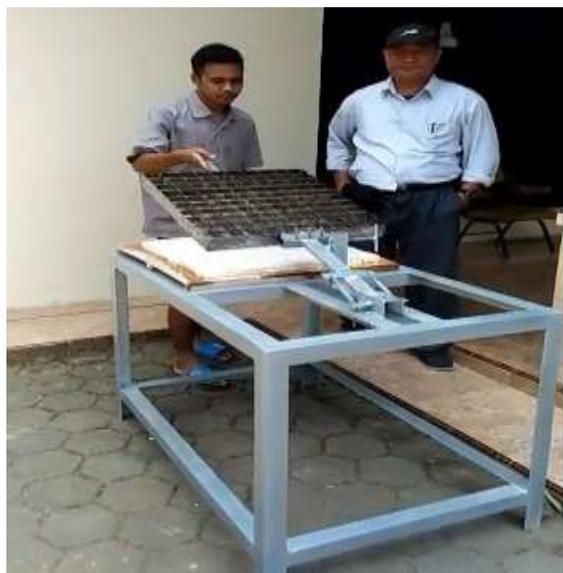
Gambar 3. Mengatur posisi pada saat proses pemotongan tahu
