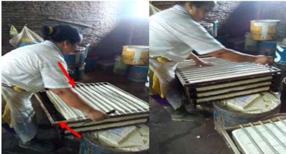
Gambar 1. Proses pemotongan tahu masih menggunakan cara tradisional
