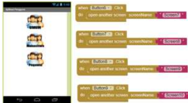
Gambar 7. implementasi dan Blok Diagram program untuk menu aktivitas untuk pengguna
