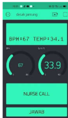
Gambar 11. Tampilan Display pada platform Blynk
